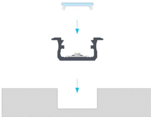
Istruzioni di montaggio del profilo "Ono" a inserimento con diffusore "Semplice".
