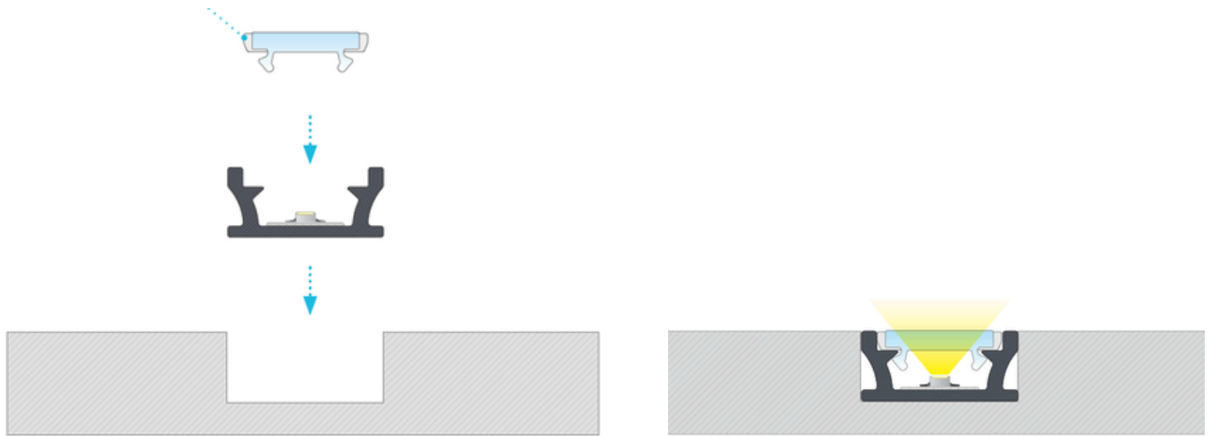
Effetto finale del montaggio del profilo "Zeno" con diffusore calpestabile.
